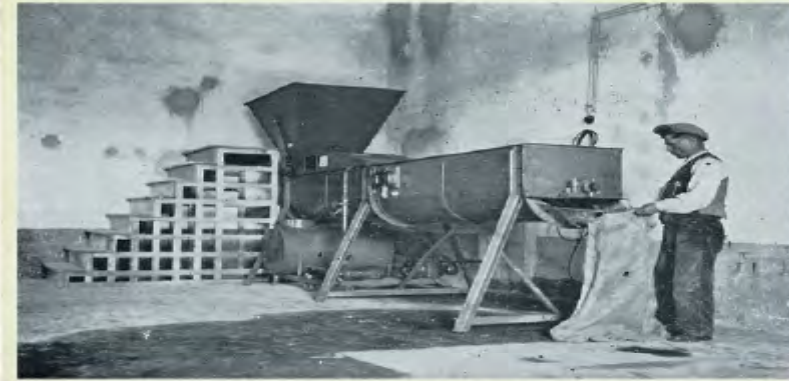
Impastatrice meccanica per la preparazione della crusca avvelenata – Nuoro. (A. Richiello – L'infestazione di cavallette in Sardegna, 1935)
